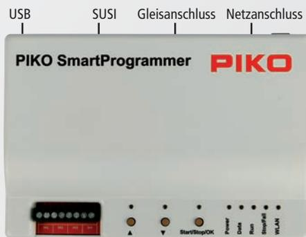
4 Anschlüsse für Sensoren (Pendelautomatik)
