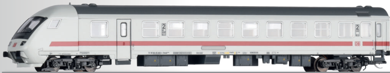
Steuerwagen 2. Klasse Bimdzf 269 der DB AG 2nd class driving cab coach Bimdzf 269 of the DB AG
