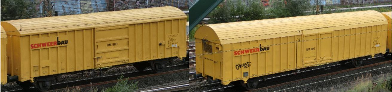
Die Gleisbaufirma Schwerbau hat in ihren Gleisbauzügen 2 Gerätewagen in Sonderbauart (ähnlich Hbis) eingereiht. Beide Wagen sind unterschiedlich lang und haben eine unterschiedliche Dachwölbung sowie Schiebe- bzw. Schwenktüren. Fotografiert wurden Sie im September 2013 in Hamburg in einem Zugverband mit einer Gleisstopfmaschine.
