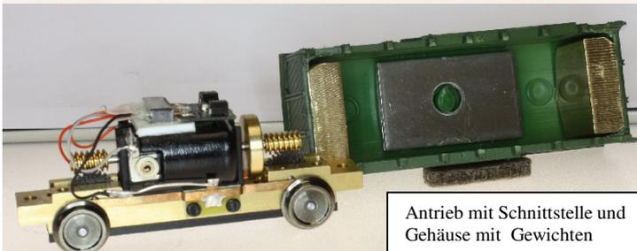
Antrieb mit Schnittstelle und Gehäuse mit Gewichten
