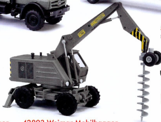
42893 Weimar Mobilbagger T 174 - 2 mit Spiralbohrer
