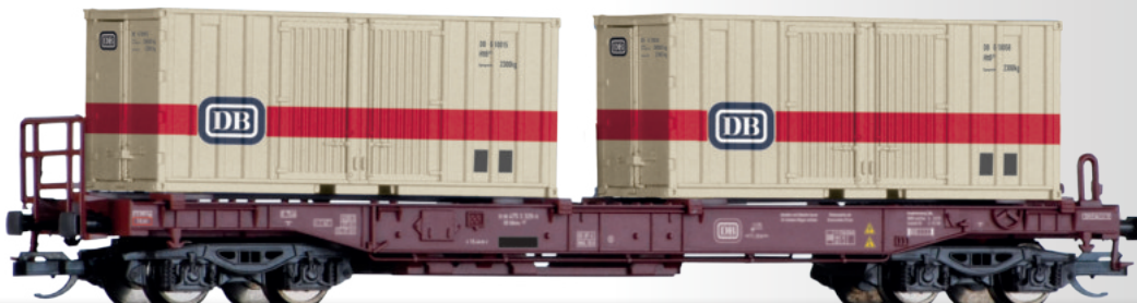
Taschenwagen Sdkms 707 der DB, beladen mit zwei Containern Pocket wagon Sdkms 707 of the DB with two 20' container
