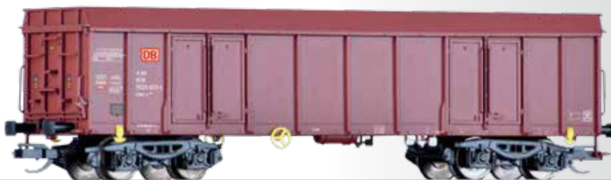
Offener Güterwagen Ealos-x 053 der DB AG Open car Ealos-x 053 of the DB AG
