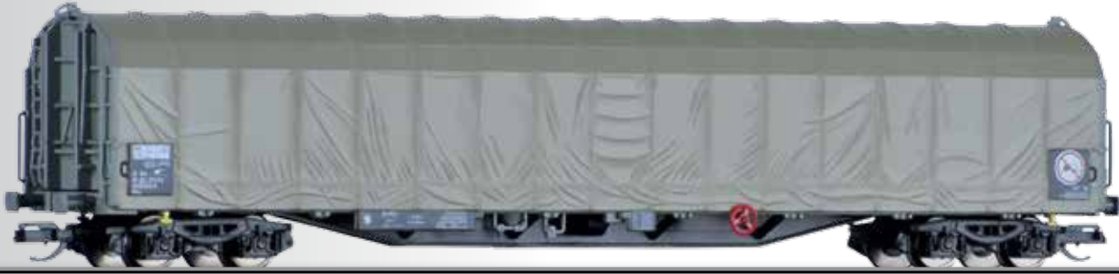
Schiebeplanenwagen Rils der ZSSK Cargo Sliding tarpaulin car Rils of the ZSSK Cargo
