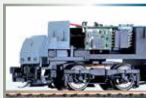
6-poliger Decoder eingebaut / Decoder 6 pole installed
