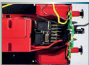
Entstörsatz eingebaut / Installed interference suppression set
