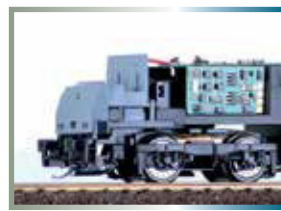
Decoder eingebaut / Installed decoder
