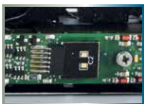
Entstörersatz eingebaut / Installed interference suppression set
