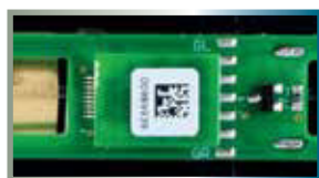
Entstörersatz eingebaut / Installed interference sup- pression set
