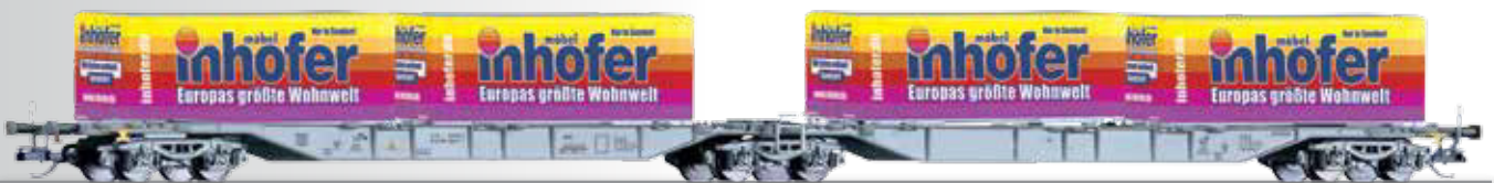
Doppeltragwagen Sggmrs 104 der AAE, beladen mit 4 Wechselkoffern „Inhofer“ Container car Sggmrs 104 of the AAE, with load
