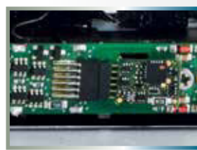
Decoder eingebaut / Installed decoder
