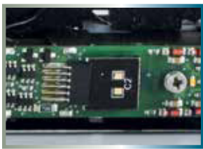
Entstörersatz eingebaut / Installed interference suppression set
