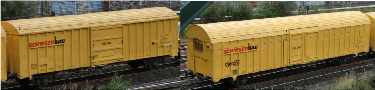
Die Gleisbaufirma Schweerbau hat in ihren Gleisbauzügen 2 Gerätewagen in Sonderbauart (ähnlich Hbis) eingereiht. Beide Wagen sind unterschiedlich lang und haben eine unterschiedliche Dachwölbung sowie Schiebe- bzw. Schwenktüren. Fotografiert wurden Sie im September 2013 in Hamburg in einem Zugverband mit einer Gleisstopfmaschine.
