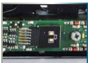
Entstörersatz eingebaut / Installed interference suppression set
