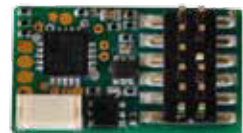
Decoder PluX 12 NEM 658 (für BR 189, TRAXX, Taurus) Decoder PluX12, NEM 658 (15,0 x 8,6 x 2,4)*
