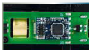
Decoder eingebaut / Installed decoder
