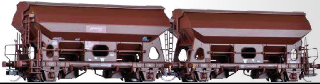
Schwenkdachwagen-Einheit Tdgrs der Railco a. s. Swing roof car unit Tdgrs of the Railco a. s.
