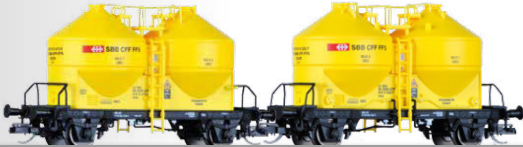
Güterwagenset der SBB, bestehend aus zwei Staubsilowagen Ucs Freight car set of the SBB with two silo car Ucs
