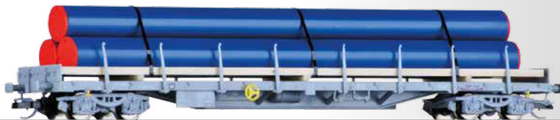
Rungenwagen Rgs der TDCC, beladen mit Rohren
