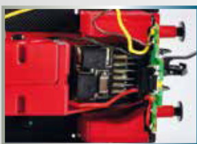
Entstörsatz eingebaut / Installed interference suppression set
