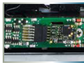
Decoder eingebaut / Installed decoder
