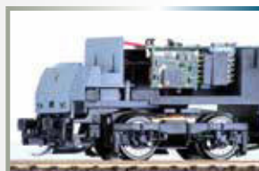
6-poliger Decoder eingebaut / Decoder 6 pole installed
