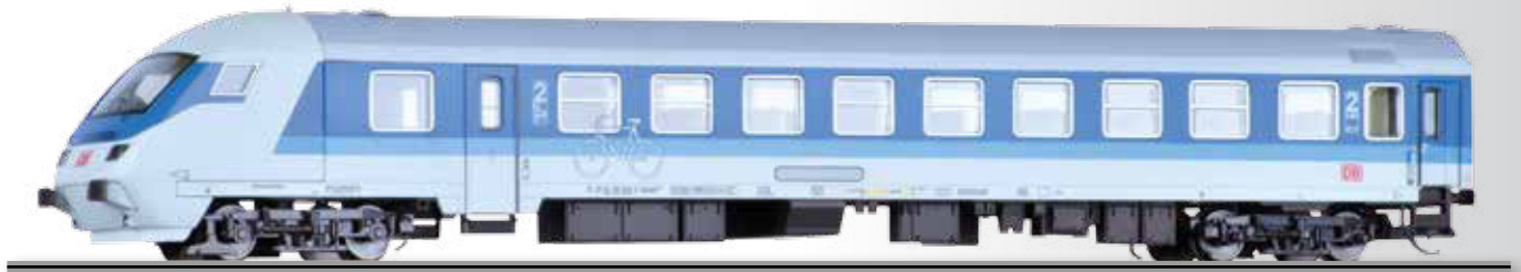
Steuerwagen Bimdzf 269 der DB AG Driving cab coach Bimdzf 269 of the DB AG
