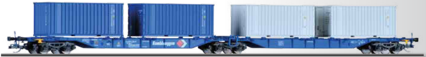
Doppeltragwagen Sggnos 715 „Kombiwaggon“ der DB AG, beladen mit unterschiedlichen Containern Container car Sggnos 715 „Kombiwaggon“ of the DB AG loaded with different container
