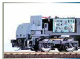
Decoder eingebaut / Installed decoder
