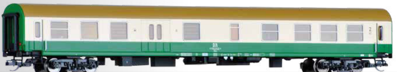
Reisezugwagen 2. Klasse mit Gepäckabteil Bdmse, Bauart Halberstadt, der DR 2nd class passenger coach with baggage compartment Bdmse, type Halberstadt, of the DR
