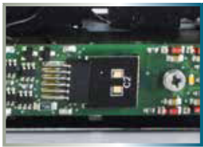
Entstörersatz eingebaut / Installed interference suppression set
