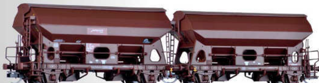
Schwenkdachwagen-Einheit Tdgrrs der Railco a. s. Swing roof car unit Tdgrrs of the Railco a. s.
