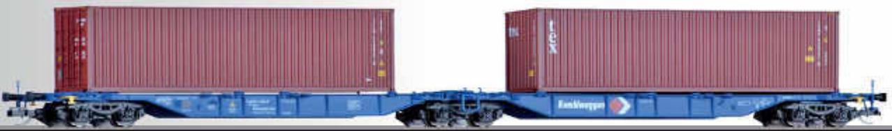
Doppeltragwagen Sggmrs 715 „Kombiwaggon“, eingestellt bei der DB AG, beladen mit unterschiedlichen Containern Container car Sggmrs 715 „Kombiwaggon“ of the DB AG loades with different container
