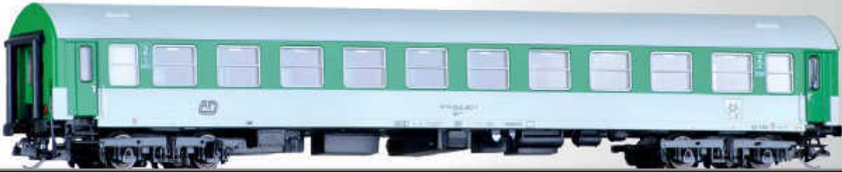
Reisezugwagen 2. Klasse, Typ Y/B 70, mit Fahrradabteil der ČD 2nd class passenger coach with bicycle compartment, type Y/B 70, of the ČD
