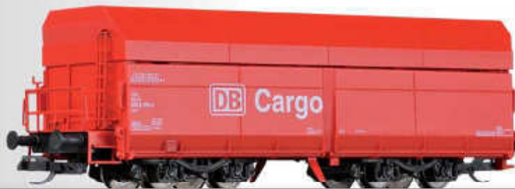
Selbstentladewagen Fals der DB AG High capacity hopper car Fals of the DB AG
