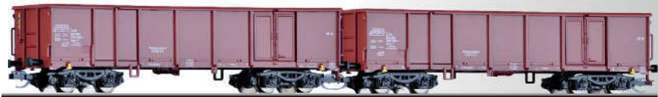
Güterwagenset der MEG, bestehend aus zwei offenen Güterwagen Eaos-x 075 Freight car set of the MEG with two open cars Eaos-x 075
