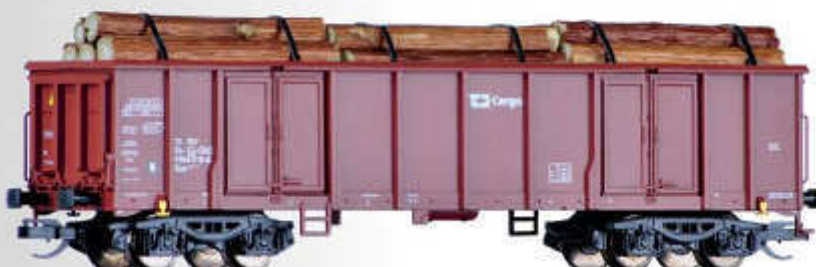
Offener Güterwagen Eas der ČD Cargo, beladen mit Stammholz Open car Eas of the ČD Cargo with load
