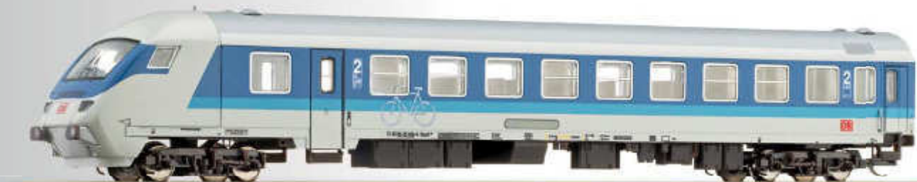
Steuerwagen Bimdzf 269 der DB AG Driving cab coach Bimdzf 269 of the DB AG
