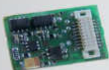
Decoder PluX12 NEM 658 (außer BR 189, TRAXX, Taurus) Decoder PluX12, NEM 658 (14,7 x 8,6 x 2,4)*
