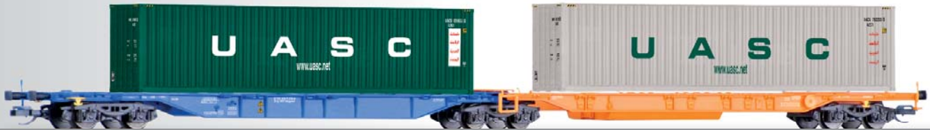
Doppeltragwagen Sdggmrs der ÖBB, beladen mit unterschiedlichen Containern Container car Sdggmrs of the ÖBB with different container
