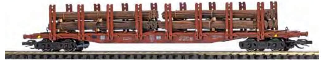
31137 Doppelrungenwagen Snps 719 mit verrosteten Rundstahlbündeln
