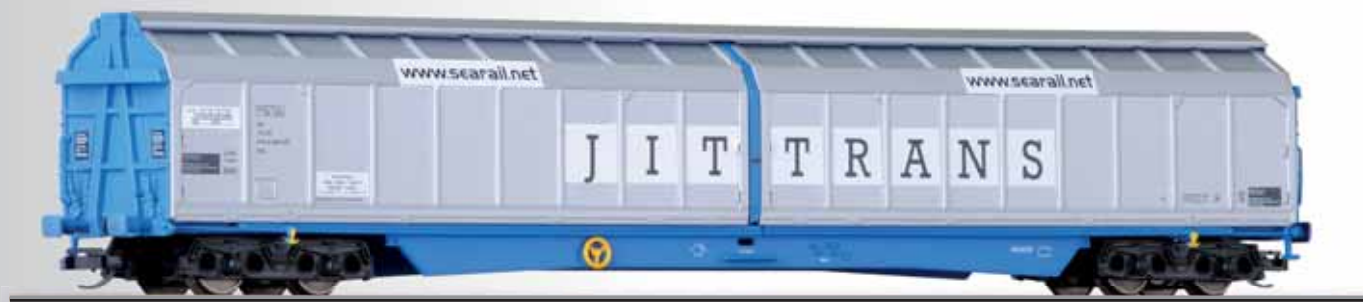
Schiebewandwagen „Jit-Trans“ der GE Rail Services, eingestellt bei der VR Sliding wall box car „Jit-Trans“ of the GE Rail Services
