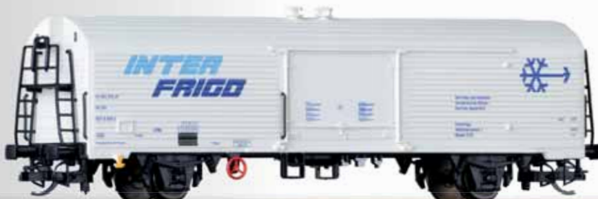
Kühlwagen Ibbhs der INTERFRIGO, eingestellt bei der DR Refrigerator car INTERFRIGO of the DR
