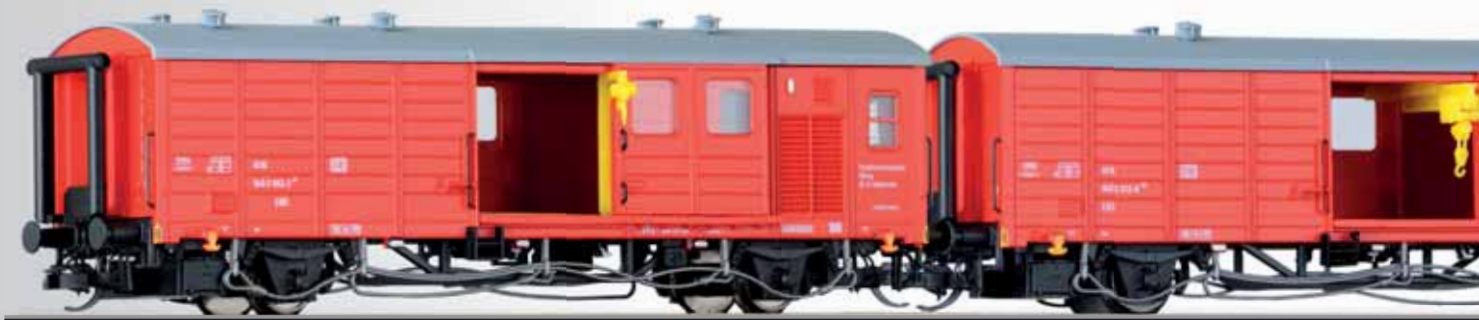
Standardhilfszug der DB AG, bestehend aus Energieversorgungs-, Geräte- und Aufenthaltswagen Standard maintenance train of the DB AG with three different cars
