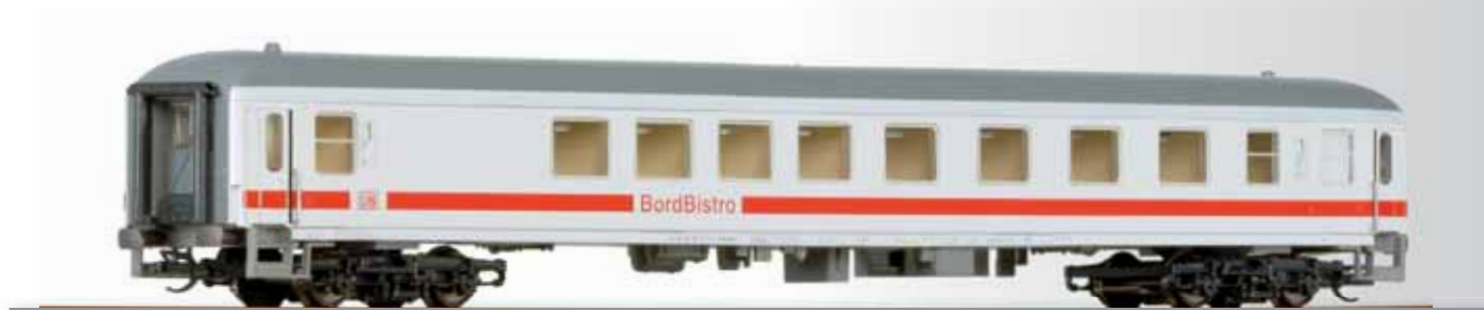
Reisezugwagen mit BordBistro, ARkimbz 262.4 der DB AG, in aktueller IC-Farbgebung Passenger coach with bistro, ARkimbz 262.4 of the DB AG, in actual IC-colouring
