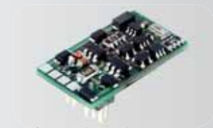
Digitaldecoder CT Elektronik DCX74D, ermöglicht zusätzliche Lichtfunktion/Decoder CT Electronic CX74D, enables additional light functions (13 x 9 x 1,5)*
