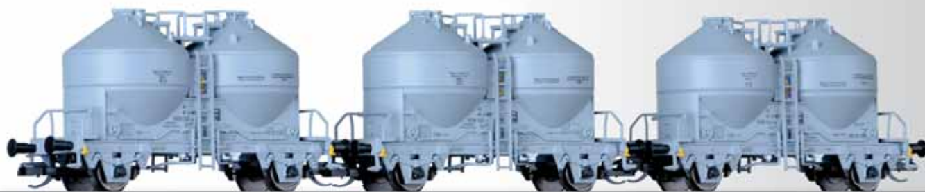
Güterwagenset der MEG, bestehend aus drei Staubsilowagen Ucs 909 Freight car set of the MEG with three different silo cars Ucs 909
