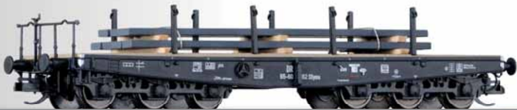
Schwerlastwagen der DR, beladen mit Flachbrennen Flat car of the DR loaded with slabs
