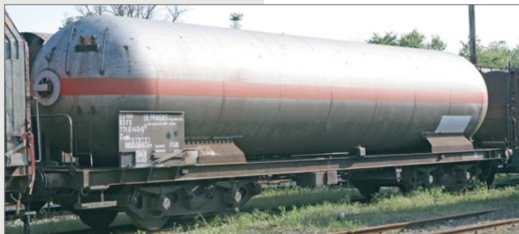
Coppia di carri cisterma Zagkk immatricolati presso le FS dalla società Ultragas. Set of two Italian Railways Zagkk tank wagons, owned by Ultragas. Set aus zwei Tankwagen Zagkk, von der Gesellschaft Ultragas bei der FS eingestellt.
