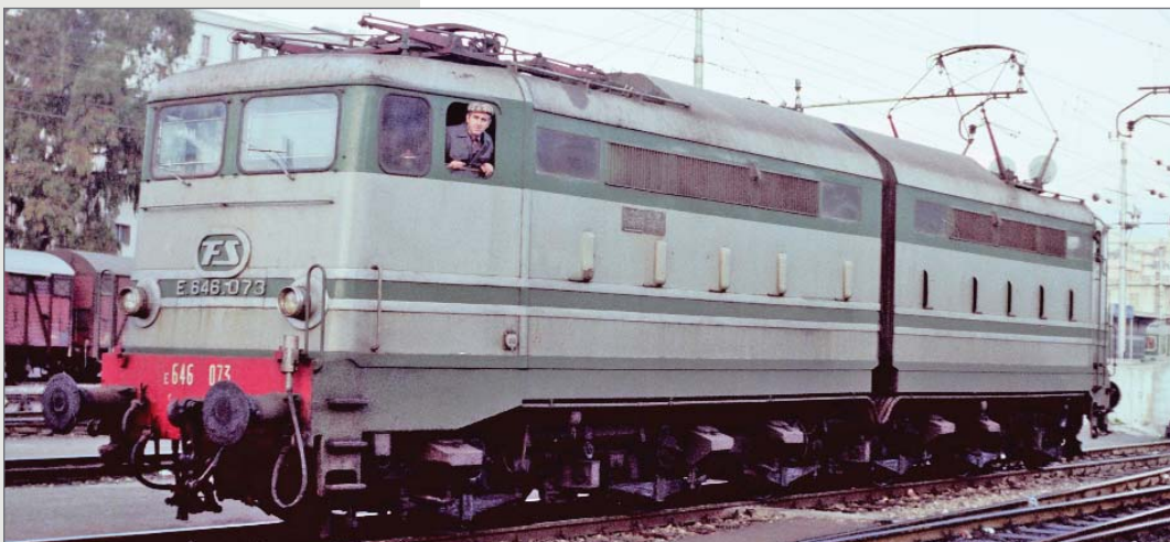
Locomotiva FS E.646.073 modificata con prese d'aria a persiana su una sola fiancata, ancora dotata di modanature. E.646.073 of the Italian Railways locomotive with modified air intakes on one side, still with mouldings. E-Lok E.646.073 der italienischen Staatsbahnen mit neuen Lüftern auf einer Seite umgebaut, noch mit Zierleisten ausgestattet.
