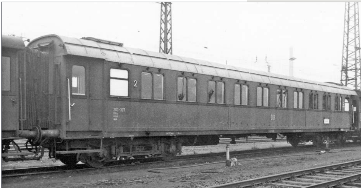
Carrozza di 2ª classe Büp 203-307, ex Cz 32000 FS, nella livrea verde delle DR. Carrelli Görlitz III. 2 nd class DR car Büp 203-307, based on italian Cz 32000 car. Green DR livery, Type Görlitz III bogies. 2. Klasse Wagen Büp 203-307 der DR, auf einem italienischen Cz 32000 basierend. Grüne DR Lackierung, Görlitz III Drehgestelle.
