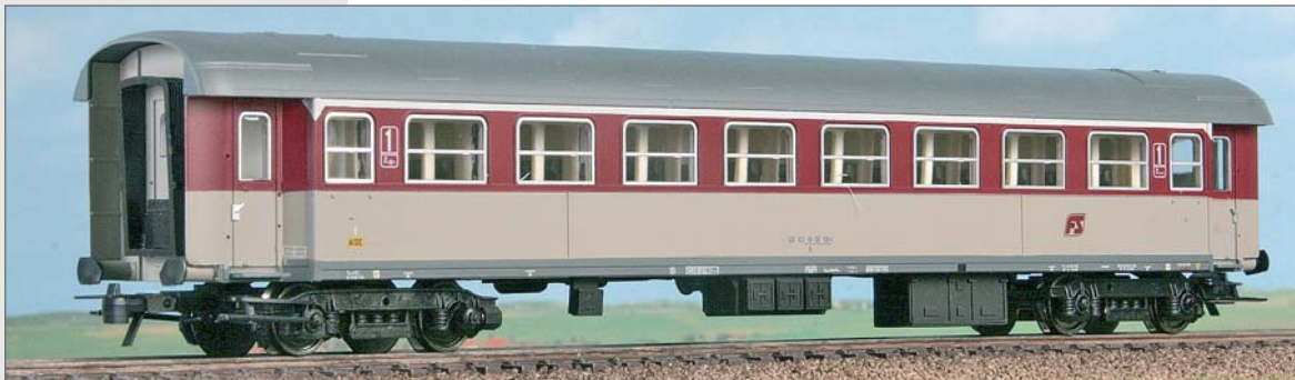
Carrozza FS di 1 a classe Tipo 1955R (Az 20500) in livrea beige e rosso fegato. Carrelli FS 24, finestrini Tipo Klein. 1 st class Type 1955R (Az 20500) car of the FS. Type FS 24 bogies, Type Klein windows, beige and deep red livery. 1. Klasse Wagen Typ 1955R (Az 20500) der FS, Typ FS 24 Drehgestelle, Typ Klein Übersetzfenster, beige und leberrote Lackierung.
