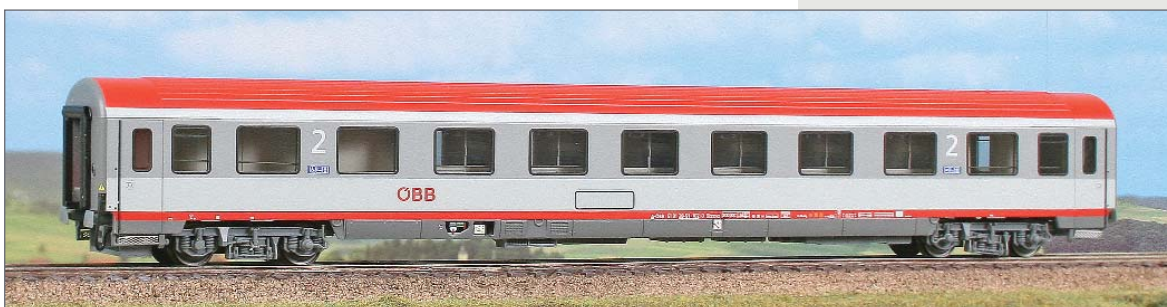
Carrozza ÖBB speciale (Bbvmz) di 2ª classe con comparti di servizio, livrea in due toni di grigio, tetto e striscia rossi. 2 nd class ÖBB Bbvmz car, two-tone gray with red stripe and roof livery ÖBB 2. Klasse Wagen (Bbvmz), zweitönige graue Lackierung mit rotem Streifen und rotem Dach.
