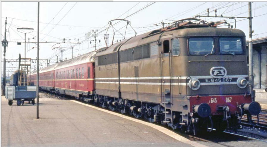
Locomotiva delle FS E.645.067 modificata con prese d'aria a persiana su entrambe le fiancate, ancora dotata di modanature. E.645.067 of the Italian Railways locomotive with modified air intakes on both sides, still with mouldings. E-Lok E.645.067 der italienischen Staatsbahnen mit neuen Lüftern auf beiden Seiten umgebaut, noch mit Zierleisten ausgestattet.
