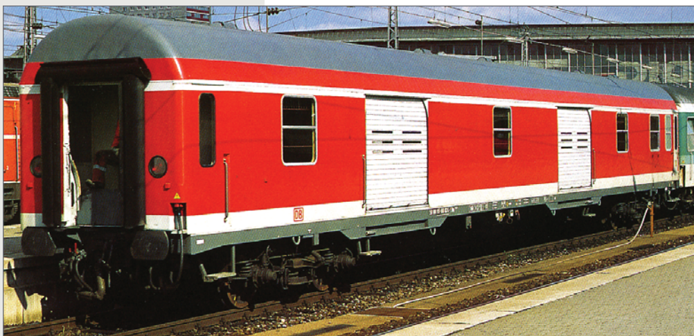
Bagagliaio Dm 922.0 in livrea DB Regio con due porte. Dm 922.0 baggage car, DB Regio livery, two doors. Dm 922.0 Gepäckwagen, DB Regio Lackierung, zwei Türen.
