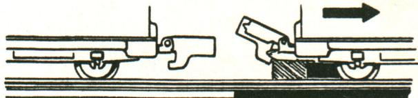
Kuppeln und Entkuppeln sollen dem Großbetrieb entsprechend bei langsamer Geschwindigkeit erfolgen. Vorbedingung für einwandfreies Kuppeln und für eine sichere Verbindung der Kupplungen ist, daß die Kupplungsteile genau waagrecht und in gleicher Höhe stehen. Verbogene Kupplungen müssen entsprechend ausgerichtet werden.
