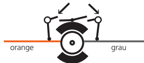
Abbildung 14: 5-poliger Märklin® Hochleistungsmotor
