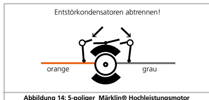
Abbildung 14: 5-poliger Märklin® Hochleistungsmotor
